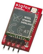
Obrázek 10 LPWAN node modulu sloužící ke komunikaci se Sigfox (41).
